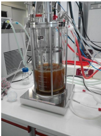
圖 3. E69 以營養培養基(NB)於 30°C 下在 10 公升發酵槽 24 小時即可培養出 \geq 10^8 CFU 的溶磷菌。
