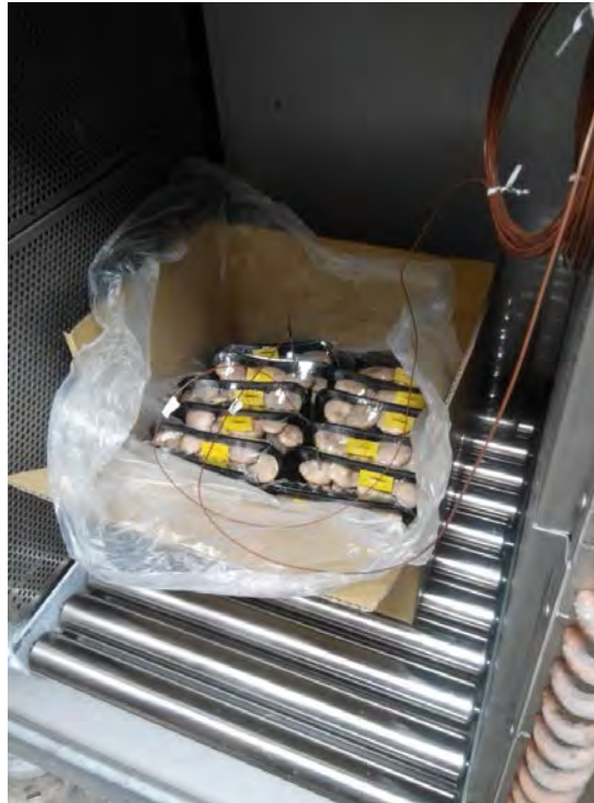
圖三、杏鮑菇以外銷香港之小盒包裝後，以真空預冷，測定溫度變化之情況。
