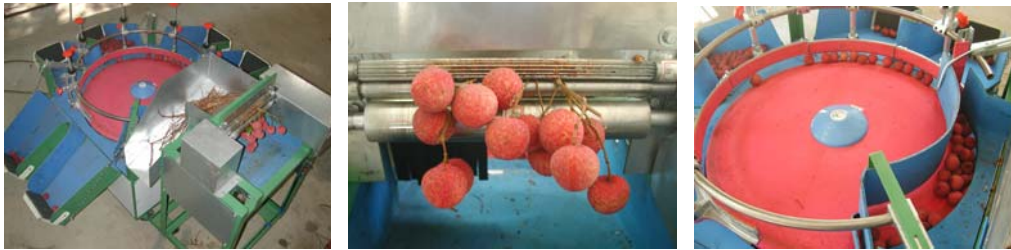
圖 6. 荔枝脫粒分級機(由左而右依次為外觀實體、脫粒與分級實況)。
