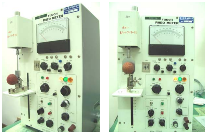
圖 1. 荔枝果梗剪力(左)與拉力(右)測定實況。
