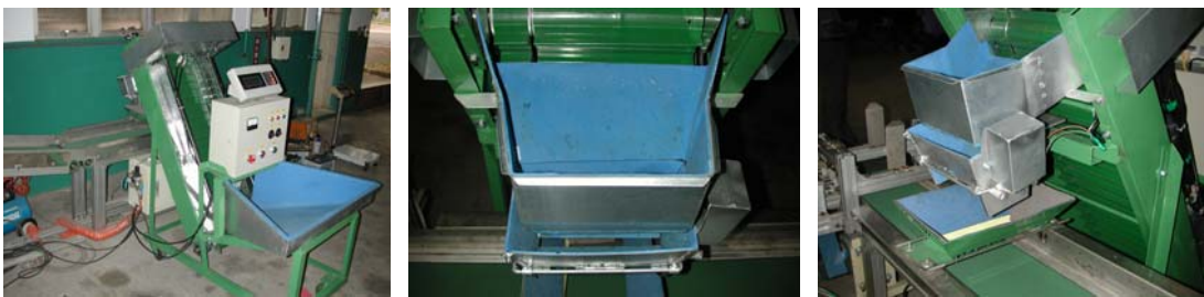
圖 10. 計重式裝填裝置(由左而右依次為入料、主與微量送料、裝填)。
