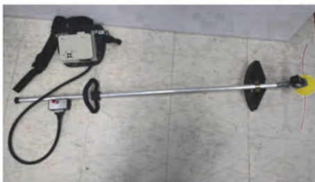
圖2 電動除草機整體架構
