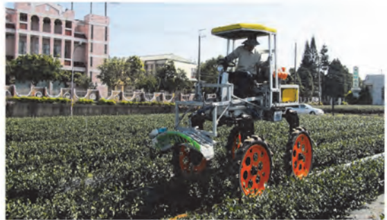
圖3 乘坐式採茶雛型機於松柏嶺茶區進行田間試驗，同時評估小苗之使用限制
