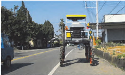
圖2 乘坐式採茶雛型機於松柏嶺茶區田間附近道路行走之狀況
