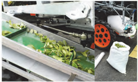
圖5 乘坐式採茶雛型機茶菁利用輸送帶輸送試驗情形
