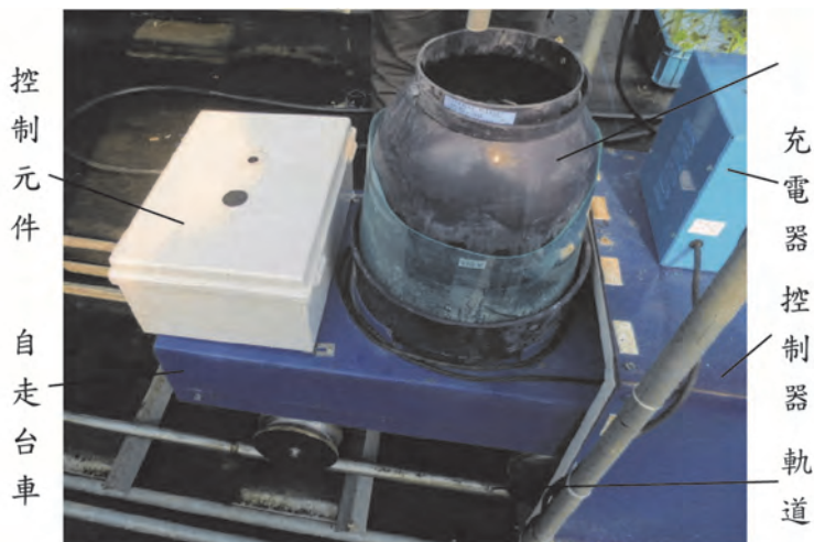
圖5 往復移動式噴霧台車組成
